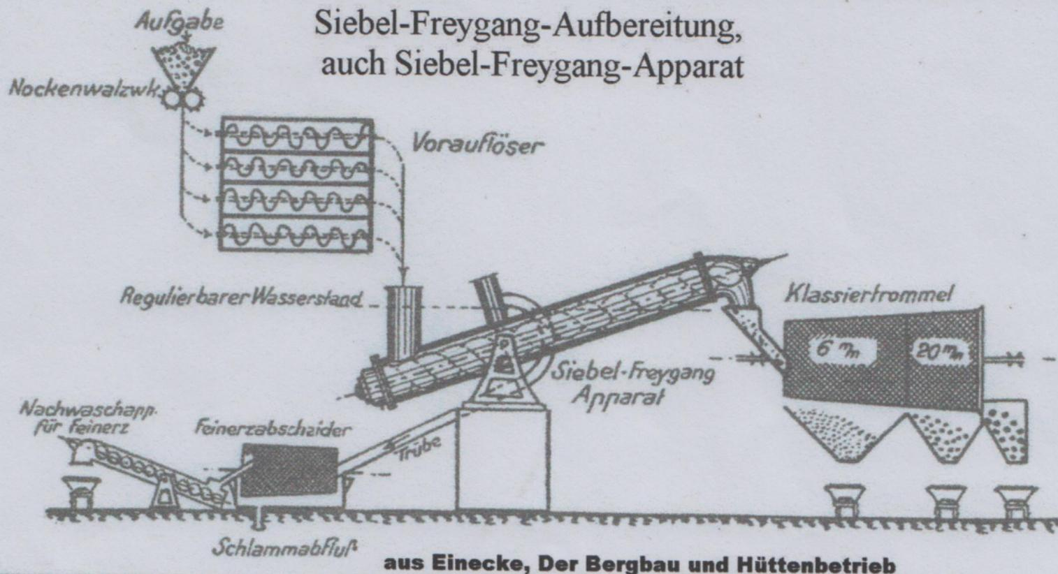
Fig. 43. Schematische Darstellung der Siebel-Freygang-Aufbereitung
