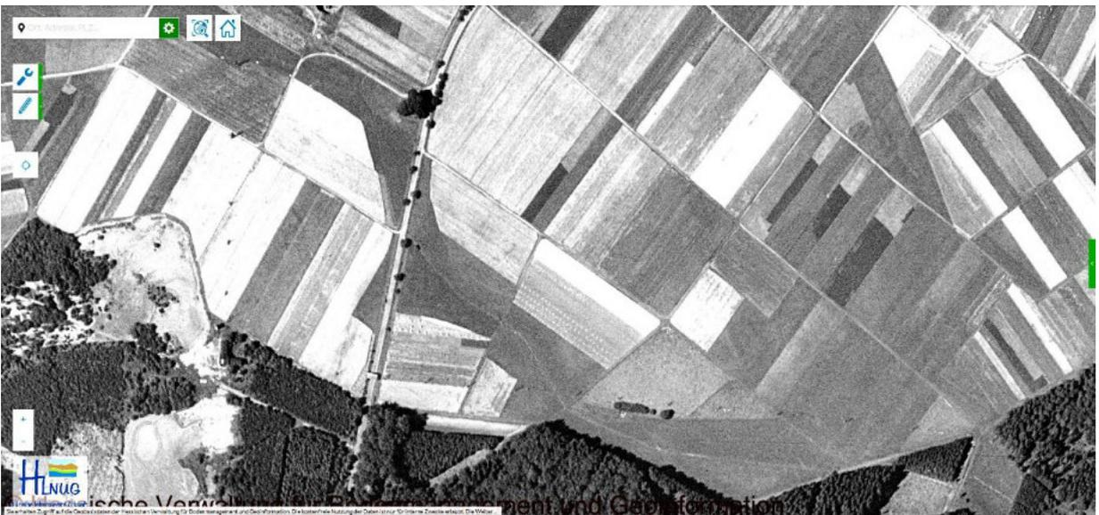
In der linken Hälfte quert von Süd nach Nord die L3072 von Atzenhain nach Bernsfeld das Bild. Im Bereich des unteren Drittels ist vage die Seilbahn zu erkennen, die rechts aus einer kleinen Lichtung heraus, über die Acker- und Wiesenflächen hinweg die Straße kreuzt und an einem L-förmigen Gebäude, der Winkelstation, endet. Die Masten sind an den regelmäßigen Abständen ihrer Schatten zu erkennen.
