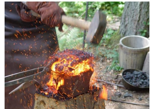
Entnahme der Luppe und Ausschmieden kohligter Rückstände und Schlacken
