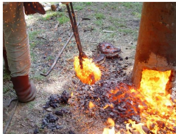
Entnahme der Luppe und Ausschmieden kohligter Rückstände und Schlacken
